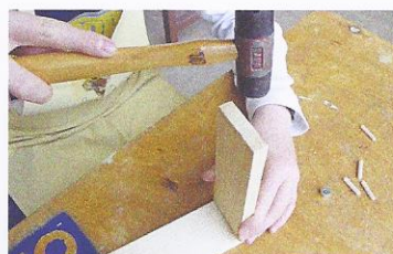
Z udarcem kladiva označimo spodnjo ploščo
