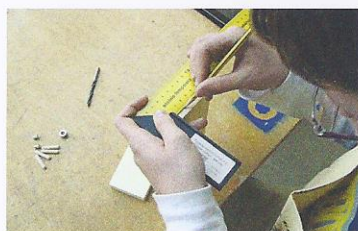
Zarisovanje lukenj v čelni del plošče
