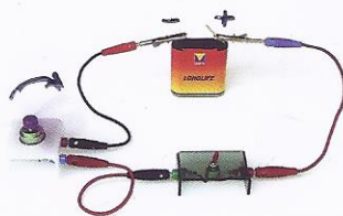
Vezava elektromotorčka z baterijo prek enopolnega stikala
