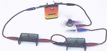
Zaporedna vezava elektromotorja in dveh enopolnih stikal
