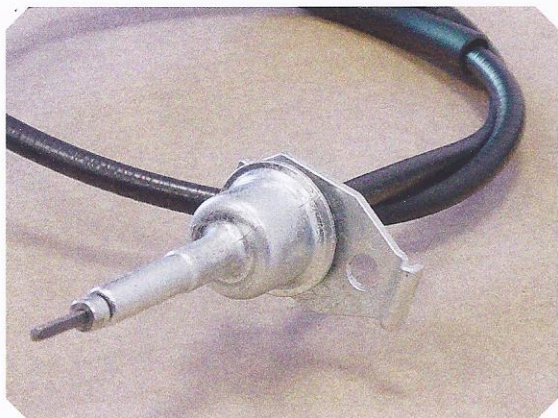
Gibljiva gred za pogon merilca hitrosti pri avtomobilu
