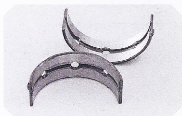
Drsni ležaj motorne gredi avtomobilskega motorja
