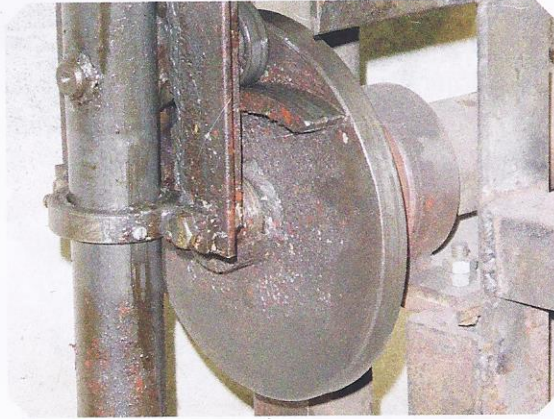
Uporaba krivuljnega mehanizma pri avtomatskem kladivu
