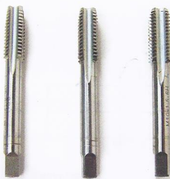
Navojni svedri za stopenjsko izdelavo navoja
