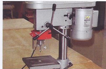
Elektromotor poganja vrtalni stroj
